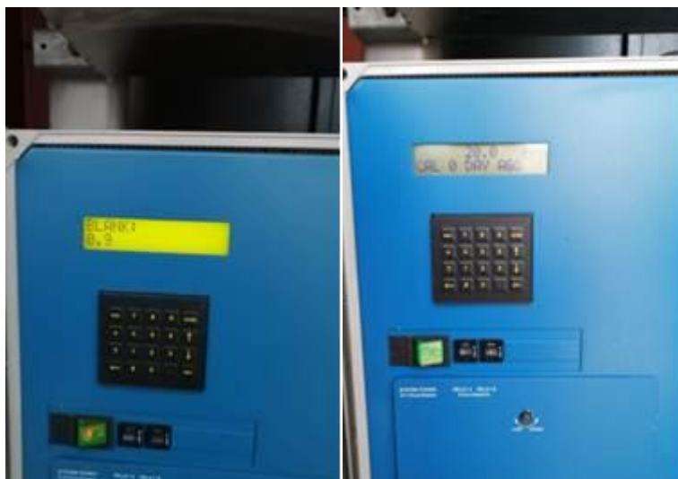
Ilustración 9. Ajuste de 0 ppm y span 20 ppm
