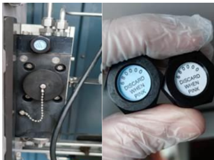
Ilustración 6. Cambio de filtro desecante
