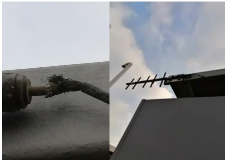
Ilustración 2. Evidencias deterioro cable de antena
