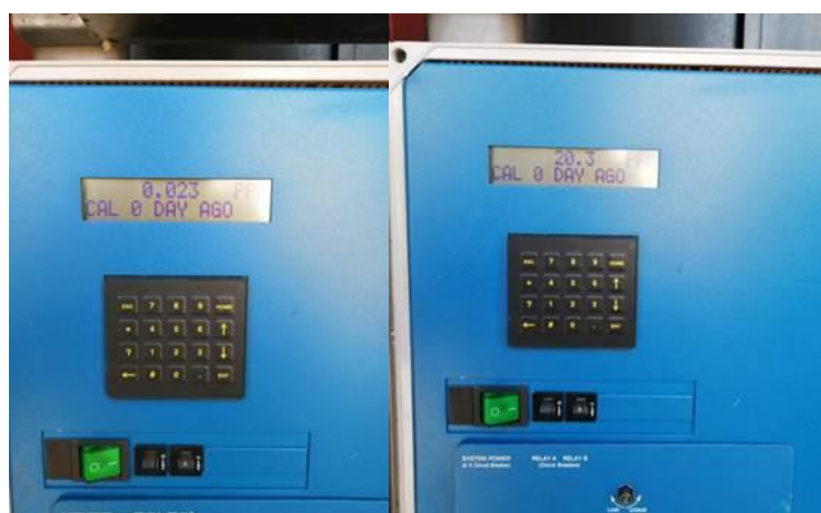
Ilustración 14. Ajuste de 0 ppm y span 20 ppm
