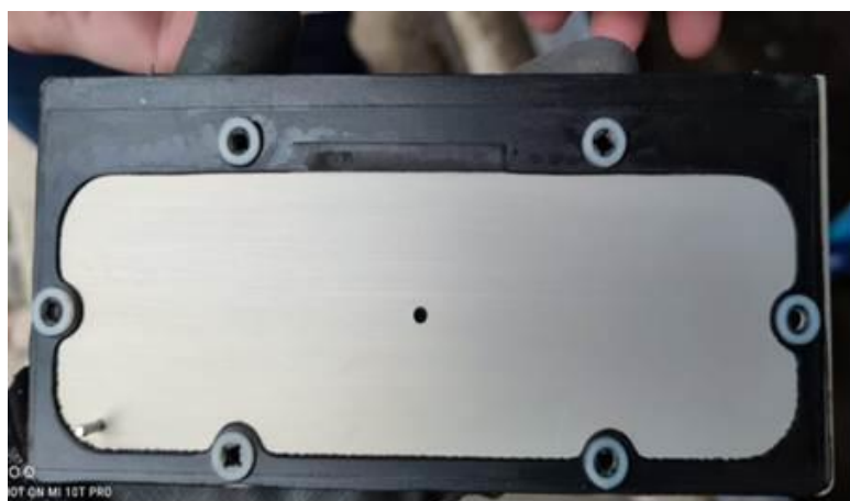
Ilustración 7. Cambio de filtro desecante
