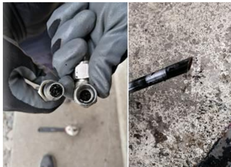
Ilustración 1. Evidencias de carbón activo en trazado neumático
