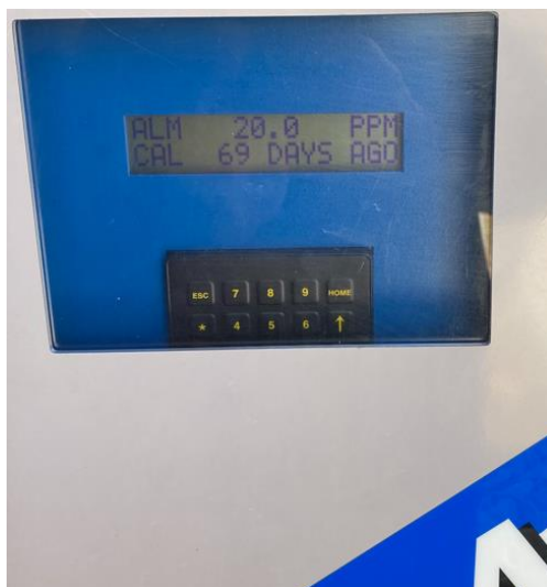
Ilustración 6. Inyección de dilución de 20 ppm
