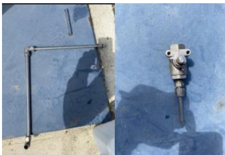
Ilustración 3. Limpieza de carbón activo en trazado neumático
